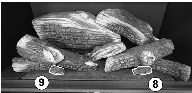
Figure 7.19. Positionnez la petite bûche droite n° 8 et la petite bûche gauche n° 9 devant les bûches n° 5 et n° 6. Ne couvrez pas les ports de brûleur.
