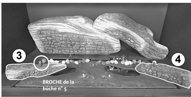
Figure 7.15. Emboîtez les orifices dans la face inférieure de la bûche du brûleur gauche n° 3 et de la bûche du brûleur droite n° 4 avec les broches correspondantes sur la plaque du brûleur comme indiqué sur la figure 7.13.
