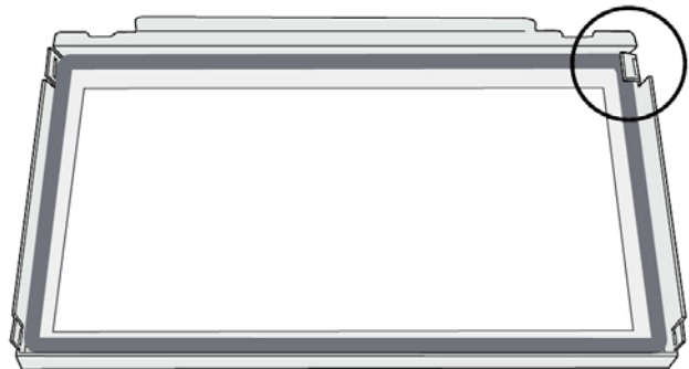
Figure 46. Pliez les languettes de fixation juste assez pour pouvoir dégager et retirer le panneau vitré.
