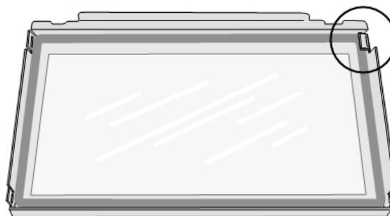
Figure 41. Dépliez les languettes de fixation juste assez pour pouvoir dégager et retirer le panneau vitré.
