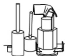
7. Réglez la commande de brûleur passer à la position «ON». Le pilote allumera. Réglez le commutateur de commande du brûleur à la «STAT» poste de contrôle thermostatique.
