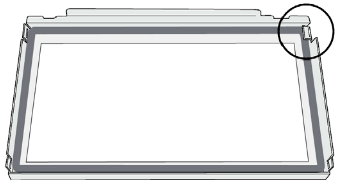
Figure 74. Dépliez les languettes de fixation juste assez pour pouvoir dégager et retirer le panneau vitré.
