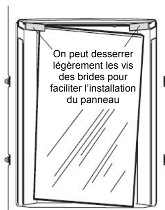
Figure 26a. Installation du panneau vitré arrière
