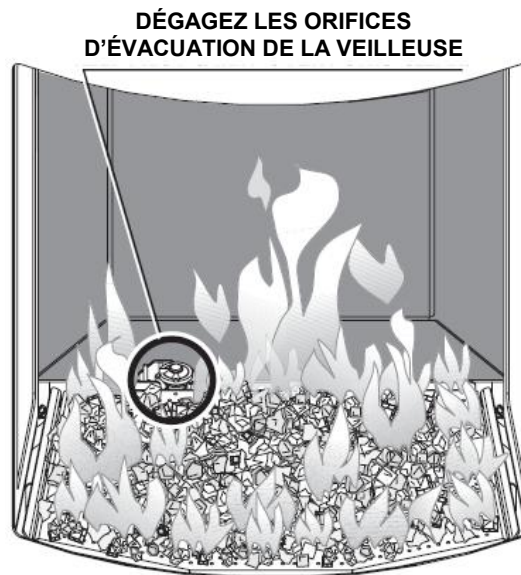
Figure 68. Apparence de flamme avec lit de verre («Starfire»).
