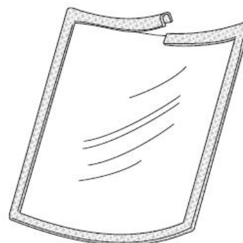
Figure 60. Installation du joint d'étanchéité (pièce n° 129124)
