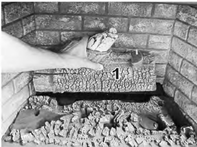
Figure 35. Bûche n° 1 : Enfoncer les trous du dessous de la bûche sur les deux tiges de la jupe arrière du brûleur.
