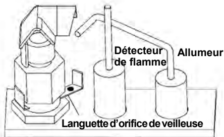
Figure 15. Conversion de la veilleuse au gaz propane.
