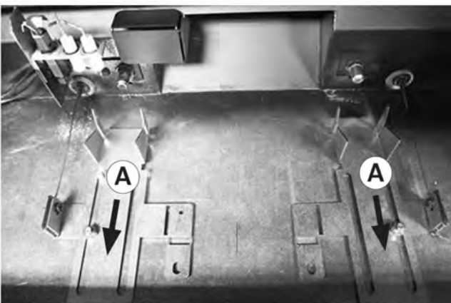
Figure 24. Ouvrir complètement les tiroirs de réglage (A) des obturateurs d'air.
