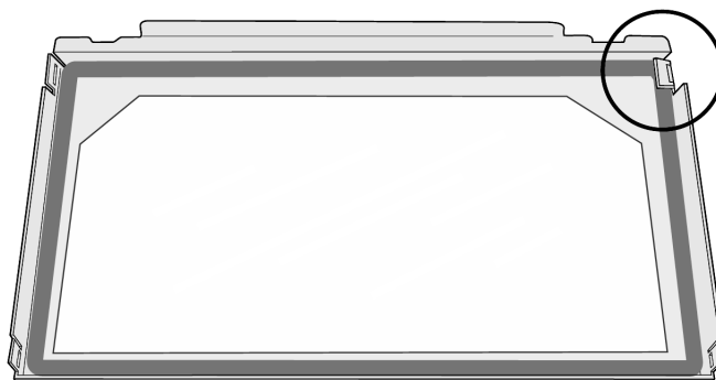
Figure 54. Dépliez les languettes de fixation juste assez pour pouvoir dégager et retirer le panneau vitré.
