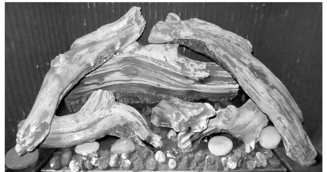
Figure 7.33. Étalez les braises du brûleur en une couche uniforme au-dessus du brûleur en acier, faites attention de ne pas bloquer la zone de la veilleuse.
