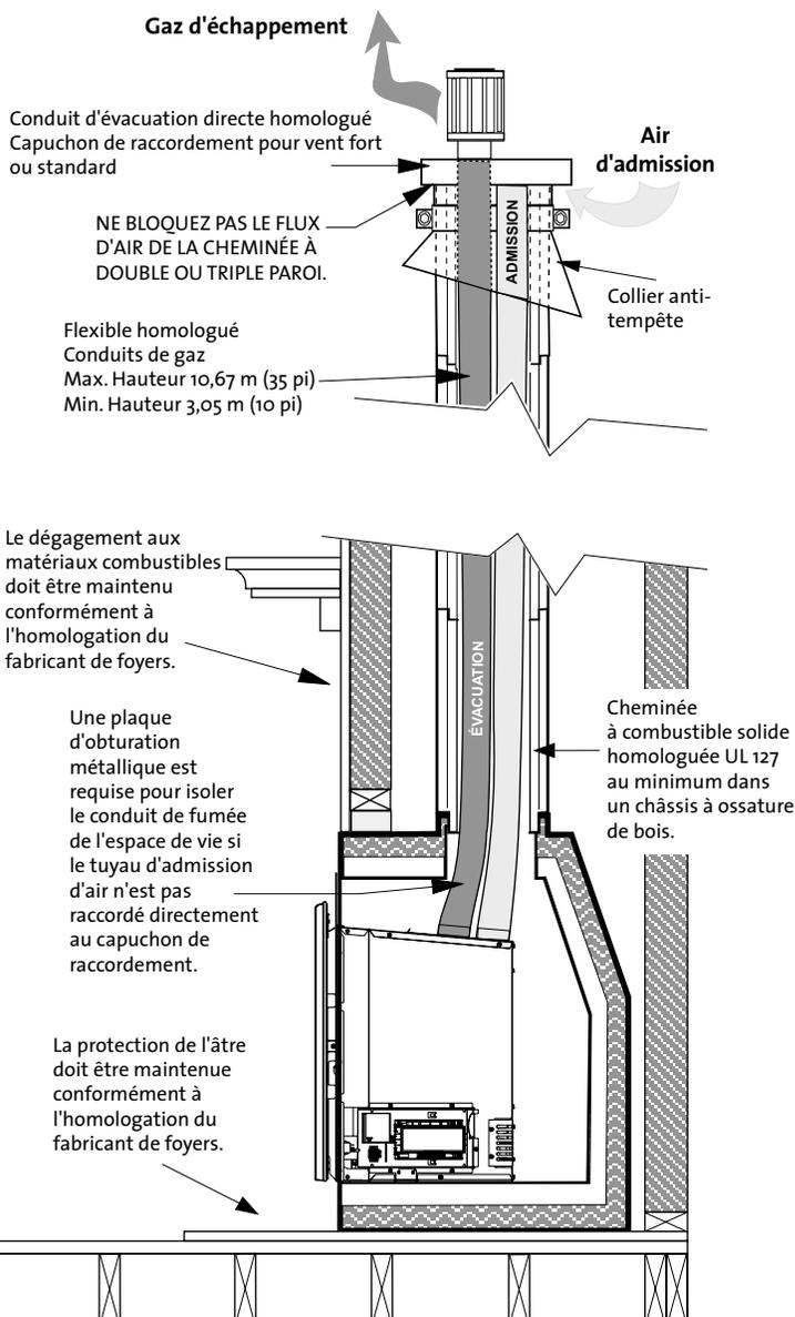
Figure 6.2. Évacuation par la cheminée du foyer préfabriqué.
