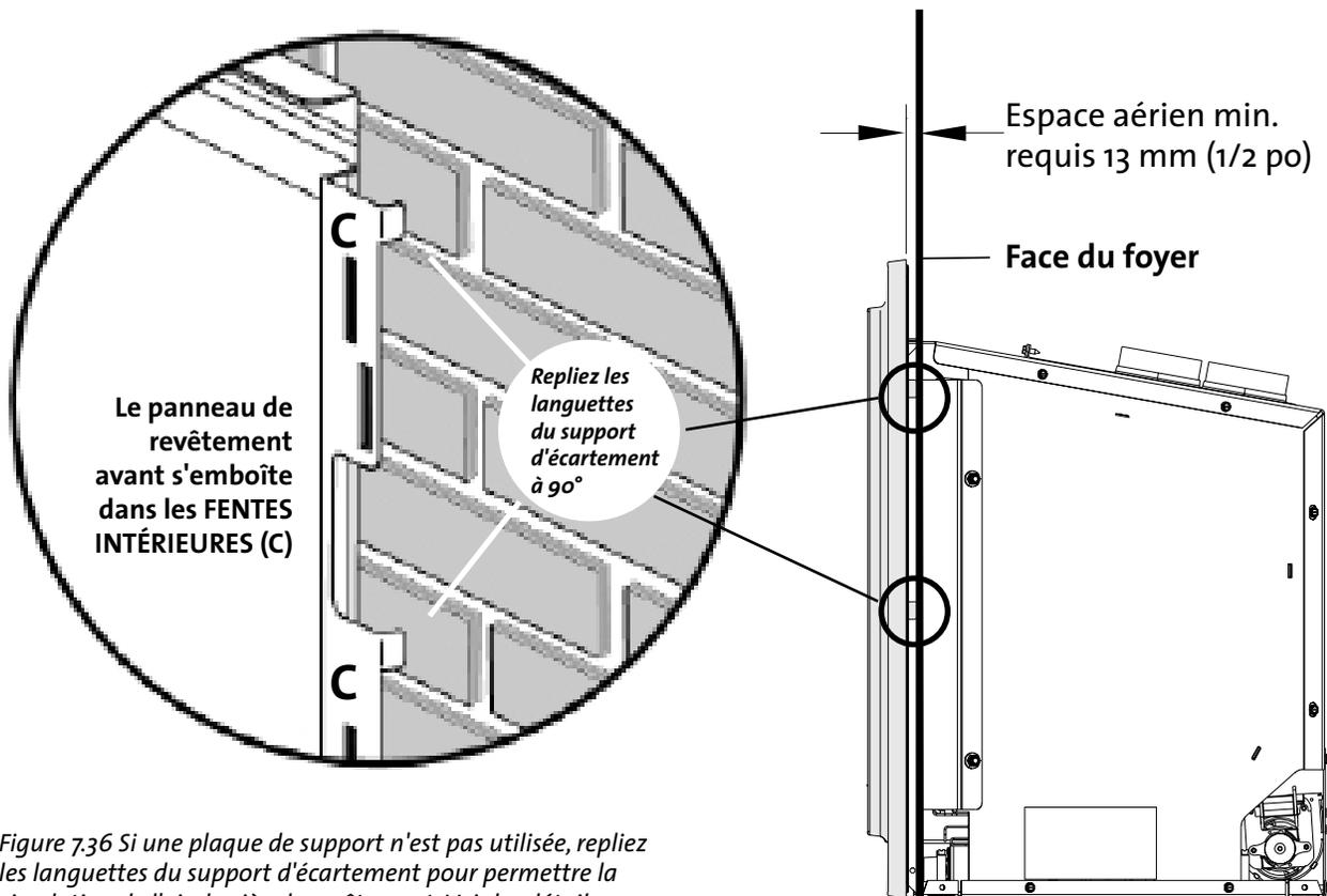
Figure 7.36 Si une plaque de support n'est pas utilisée, repliez les languettes du support d'écartement pour permettre la circulation de l'air derrière le revêtement. Voir les détails.
