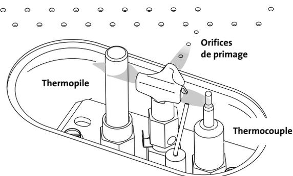
Figure 8.2. Apparence correcte de la flamme de veilleuse.
