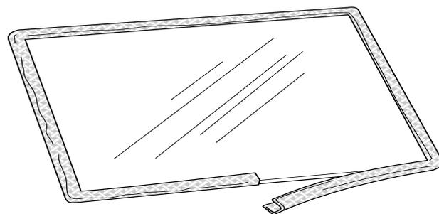
Figure 9.1. Application du joint d'étanchéité, NP 129124.
