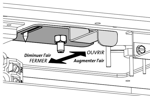
Figure 8.3. Réglage de l'obturateur d'air
