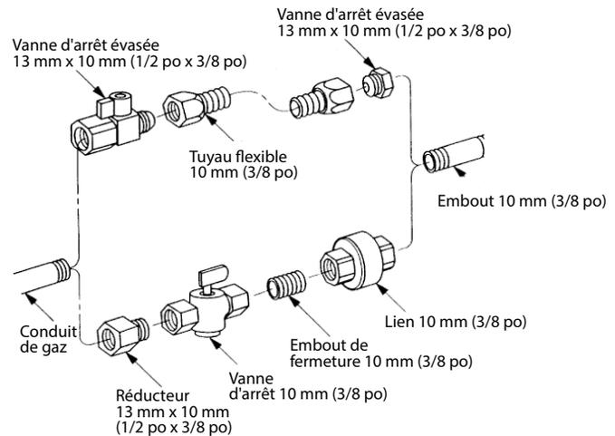
Figure 7.1. Composants externes de raccordement au gaz.
