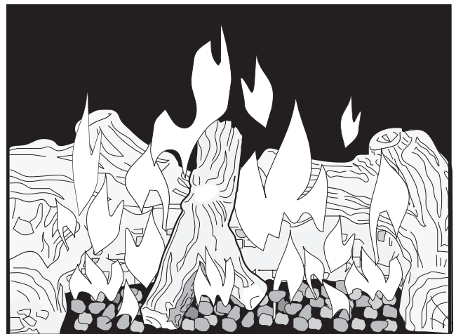
Figure 31. Apparence des flammes au réglage maximal («High») après environ 15 à 20 minutes de chauffage.
