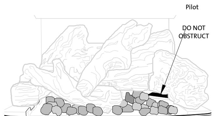
Figure 24a. Positionner les braises lâches et maintenir un dégagement de 1/4" des bords de la jupe du brûleur.
