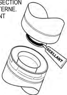
Figure 13. N'UTILISEZ AUCUN SCELLANT À BASE DE SILICONE
