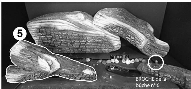
Figure 7.16. Emboîtez les orifices dans la face inférieure de la bûche transversale gauche n° 5 avec la broche sur la bûche n° 3 et la broche correspondante sur le brûleur en acier comme indiqué sur la figure 7.15.
