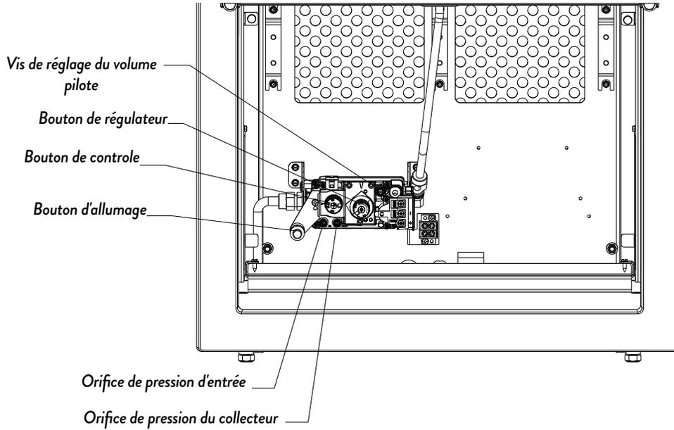
Figure 15.1. Compartiment des commandes GF 520 DV.
