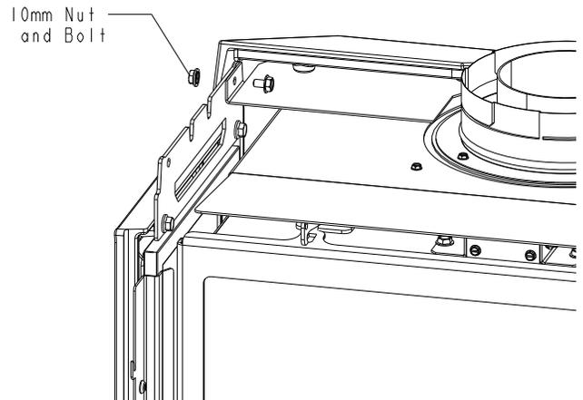
Figure 16.2. Retirez l'écrou et le boulon du haut arrière de l'assemblage latéral
