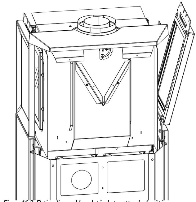
Figure 16.2. Retirez l'assemblage latéral et mettez-le de côté.
