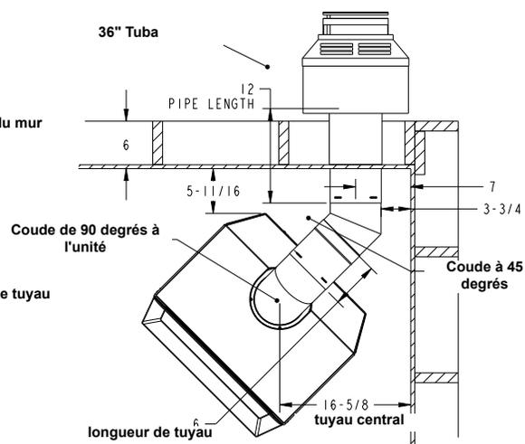
Figure 6.7. Dégagements d'installation en angle en option
