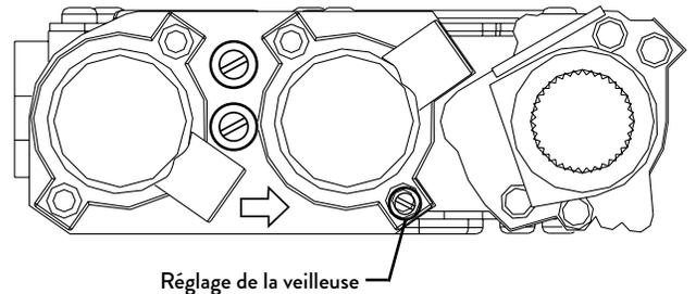
Figure 13.2. Régulation de la flamme de la veilleuse.
